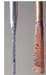
Zn anoda Cu katoda
